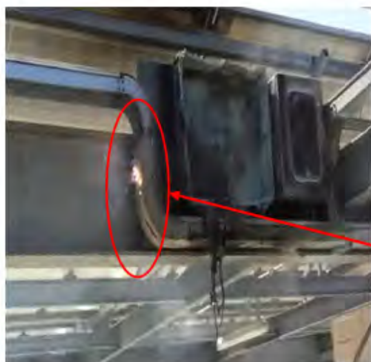
Lunghezza di fiamma di un arco elettrico in continua su impianto da 6kw – il colore della fiamma ne indica l'elevata temperatura
