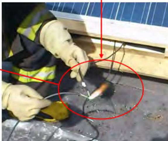
Lunghezza di fiamma di un arco elettrico in continua su impianto da 6kw – il colore della fiamma ne indica l'elevata temperatura
